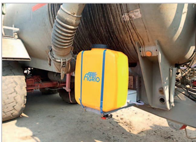
Dávkovací zařízení inhibitoru Vizura, vlevo mobilní na cisterně, vpravo stacionární instalované u jímky na kejdu Foto archiv firmy
